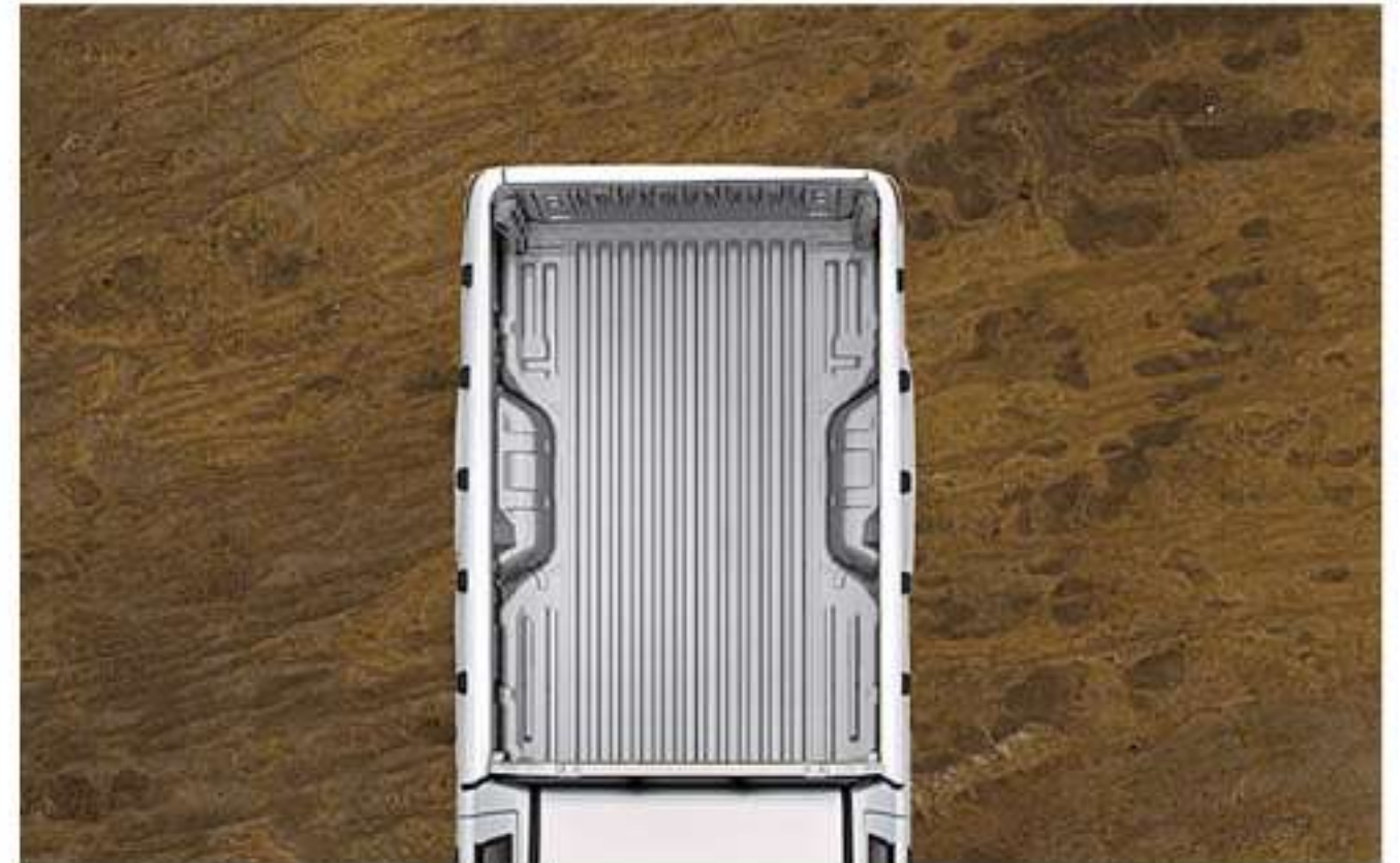
Capacidad de la caja de carga (Cabina Simple) Volumen: 1,8 m 3 . Profundidad: 511 mm.
