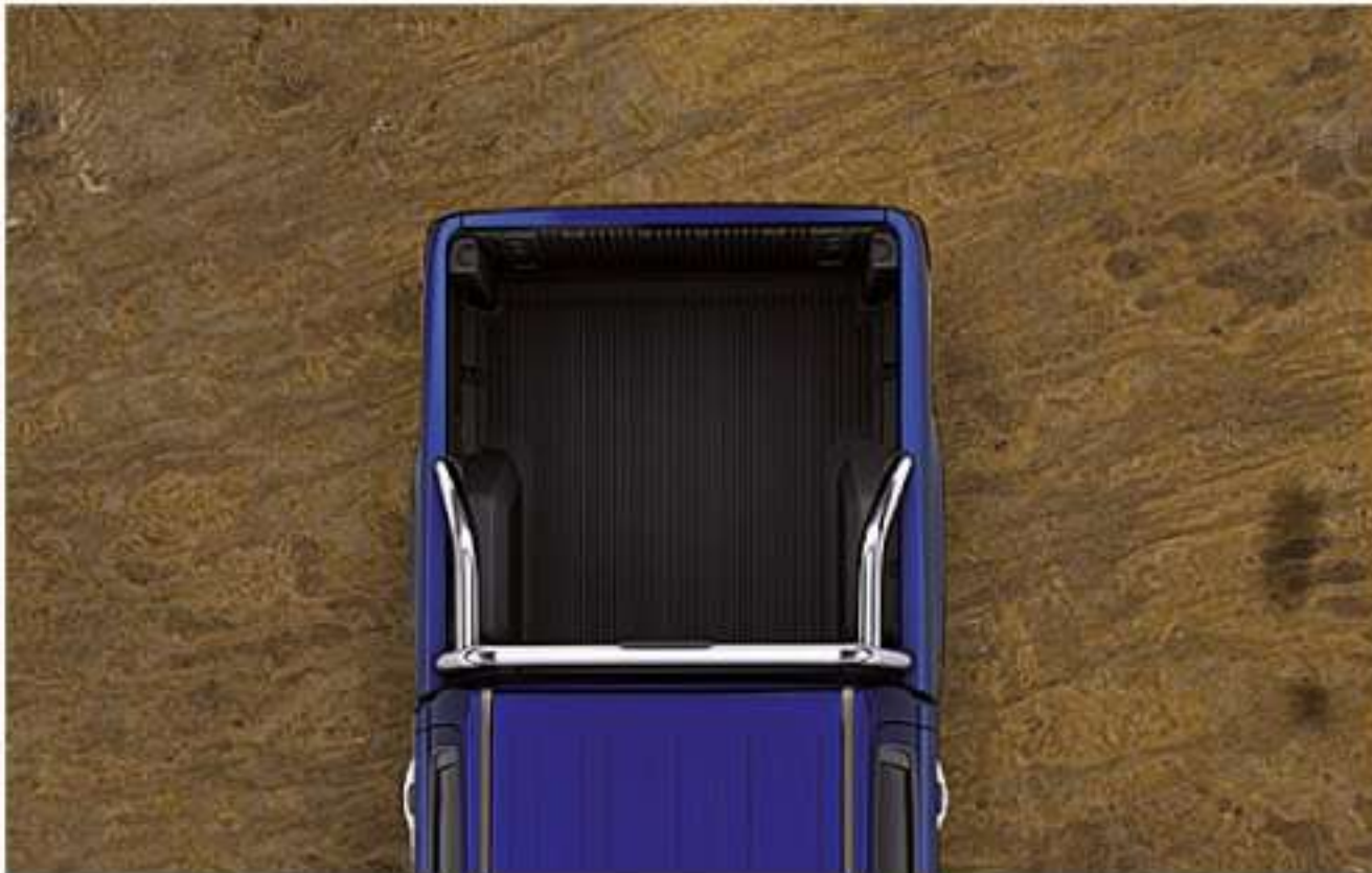
Capacidad de la caja de carga (Cabina Doble) Volumen: 1,18 m 3 . Profundidad: 511 mm.
